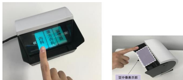
空中に浮かんだボタンを操作する様子 [空中入力装置](右側は、空中像表示部の位置。左側のボタンが点線部分に浮き出て表示される) (日立オムロンターミナルソリューションズ株式会社様提供)
